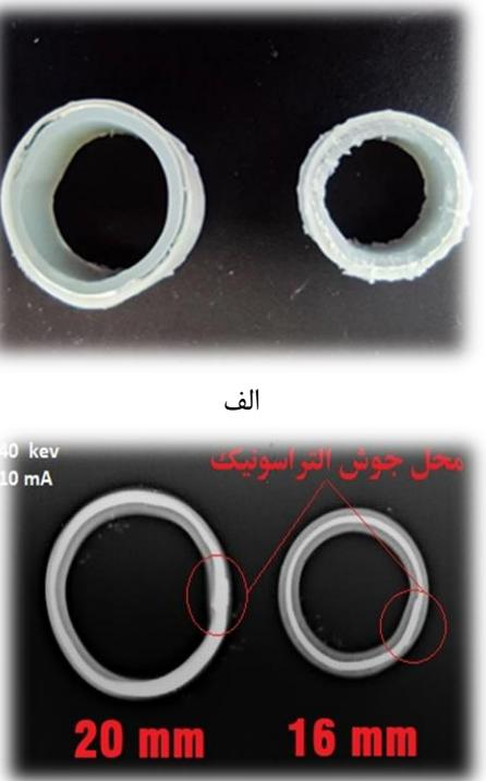
تصاویر رو به رو توسط سامانه های رادیوگرافی بهیار از مقاطع لوله های ۱۶ و ۲۰ میلیمتر ۵ لایه گرفته شده است. با استفاده از سامانه های رادیوگرافی X-Ray می توان کنترل کیفیت دقیق در خطوط تولید انواع لوله های صنعتی را ایجاد کرد.
