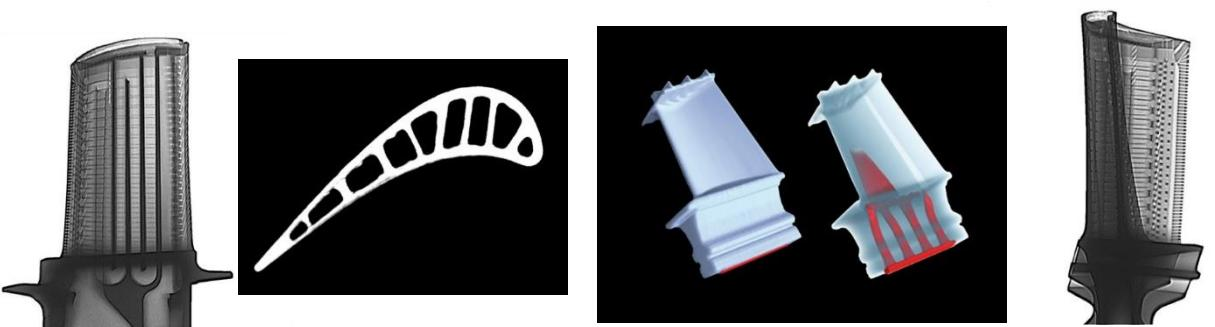
تصاویر ۳بعدی از Blade با استفاده از سامانه میکرو سی تی
